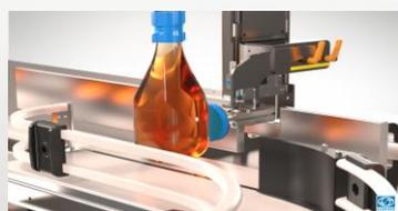
**Sleeve-Schneidetisch für eine zuverlässige und kontrollierte Klebestelle**
